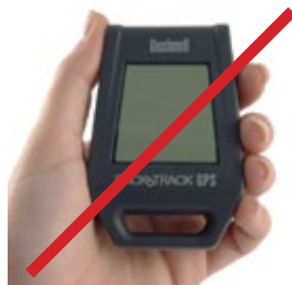
Posición de utilización incorrecta
